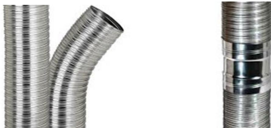
*Kada sanaciju nije moguće izvesti krutim cijevnim elementima ( jednostjeni dimovodni elementi ), koriste se duplostjene fleksibilne cijevi, izrađene od nehrđajućeg čeličnog lima u dva sloja. Unutarnja stjenka je glatka i omogućava dobro strujanje dimnih plinova te odvođenje kondenzata. Materijal:- unutarnja stijenka (INOX 316 L) - vanjska stijenka (INOX 304)*
